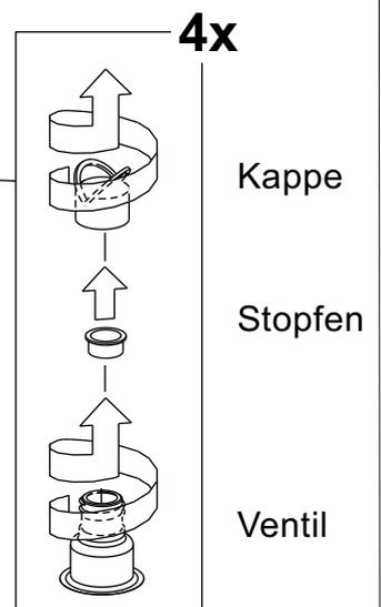
**4** Schließen Sie den Schlauch und die Füllkopplungen an. Achtung: Bei einer Duo-Ausführung die Wasserkerne gleichzeitig befüllen!
