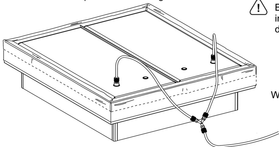
! Bei einem Duo die Wasserkern immer gleichmäßig leeren, sonst droht Verformung.
