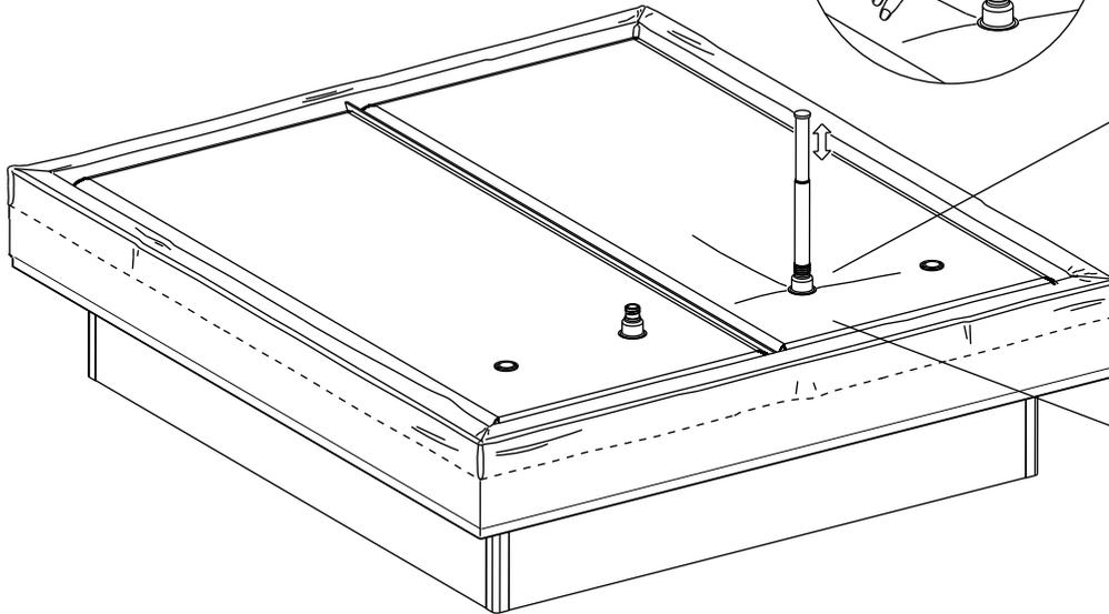
Drehen Sie anschließend mit einer Drehbewegung nach unten den Ventilverschluss gut fest.
